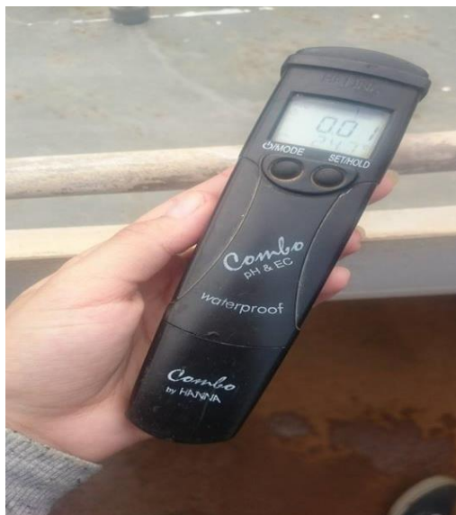
Figura 6 - Multiparâmetro (usado para medir o pH da solução)
