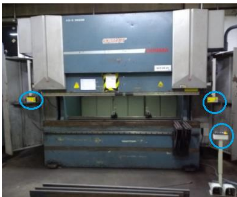
Foto 2 – Máquina com vista frontal com Sensores a Laser instalados
