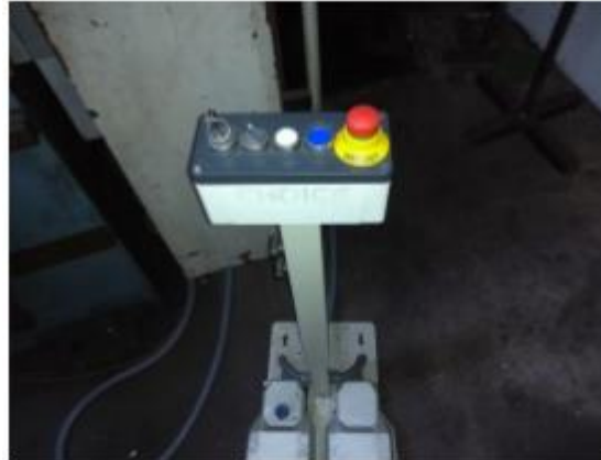
Foto 8 - Pedestal com pedal de acionamento com 3ª posição e monitorado
